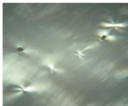
图 62 4 英寸 4H-SiC (0001) Si 面微管聚集区的偏振光双折射图像
