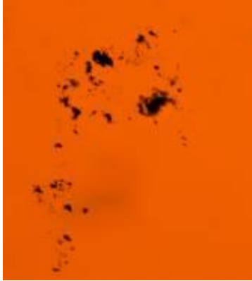
图 73 PVT 法生长的 4H-SiC 晶体中碳包裹体 光学图像
