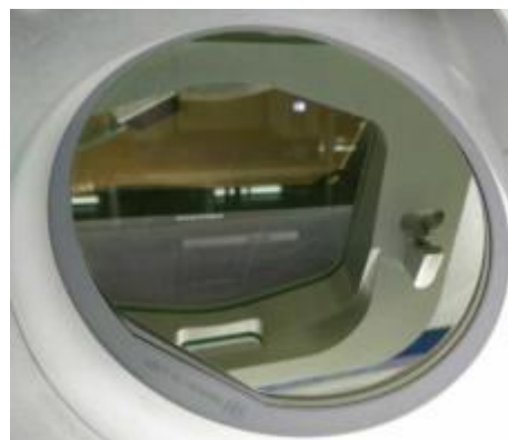
图 24 6 英寸 4H-SiC 外延晶片照片（外延层厚度 12 \mu\text{m} ）
