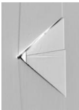
图 157 三角形缺陷的光学形貌图像
