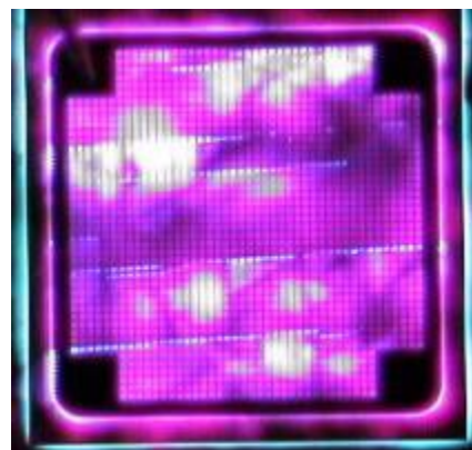
图 27210kV PiN 二极管层错产生的 EL 图像
