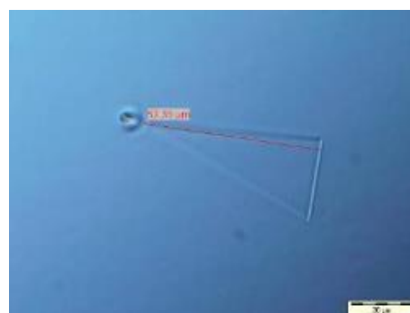
图 162 位错引起的三角形缺陷光学图象
