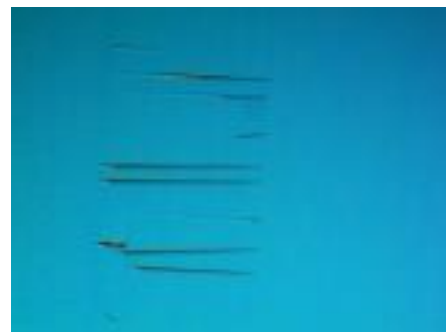
图 176 隐含划痕引起的直线型缺陷
