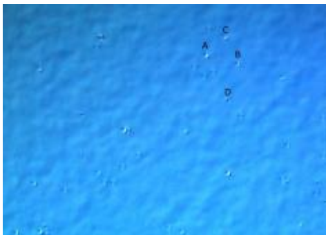
图 181 小坑缺陷（放大倍数 1000）
