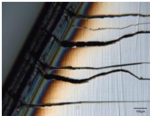
图 209 外延凸起缺陷
