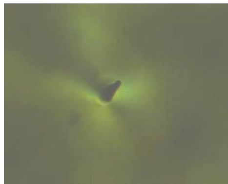
图 58 大尺寸微管的透射偏振光图像
