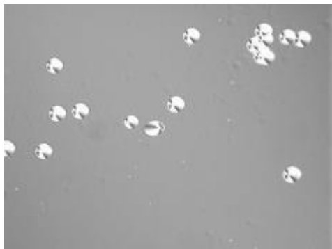
图 251 外延层中 TED 位错的 KOH 腐蚀坑图像
