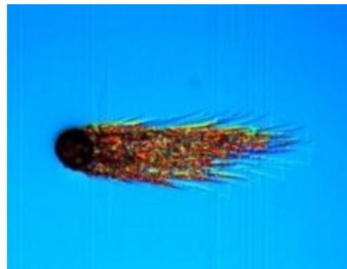
图 166 彗星缺陷的光学图像
