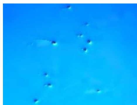
图 72 4H-SiC 晶体中微管聚集区贯穿到外延层表面的形貌缺陷图像 (600 倍)
