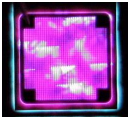
图 27110kV PiN 二极管层错产生的 EL 图像
