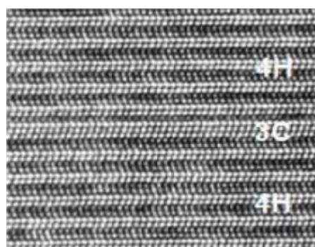
图 224 单 Shockley 型层错 (1SSF, Zhdanov 标记为 (1, 3), 呈现 4H/3C/4H 结构)
