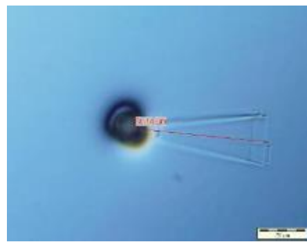
图 156 在 4H-SiC 外延层表面形成的以颗粒物为头三角形貌缺陷图像
