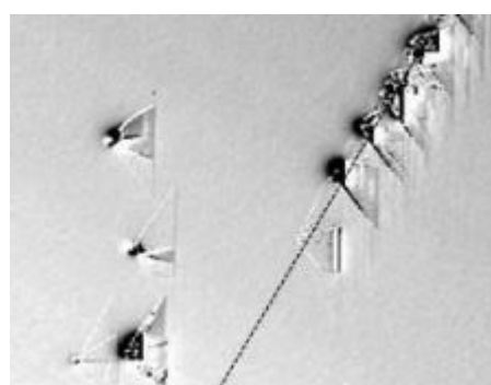
图 142 划痕引起的三角形缺陷
