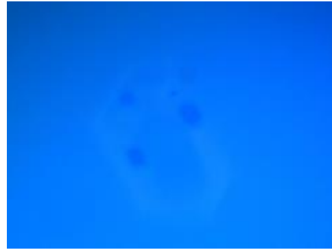
图 74 PVT 法生长的 4H-SiC 晶体中碳包裹体 光学图像
