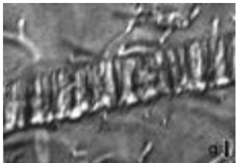
图 135 衬底表面划痕 X-射线形貌
