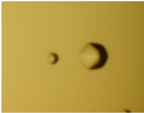
图 243 TSD 的 KOH 蚀坑图像 (400 倍)
