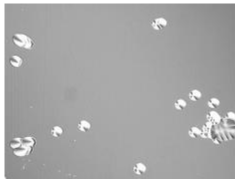
图 252 外延层中 TSD、TED 及 BPD 位错的 KOH 腐蚀坑图像
