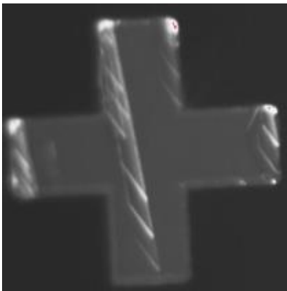
图 283 源于台面侧壁的缺陷传播 (p+nn+二极管, 30min)
