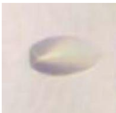
图 109 BPD 位错蚀坑
