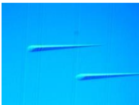
图 169 胡萝卜缺陷的显微图像
