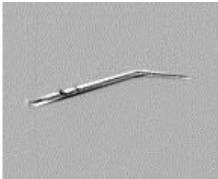
图 175 向下弯曲的直线型缺陷
