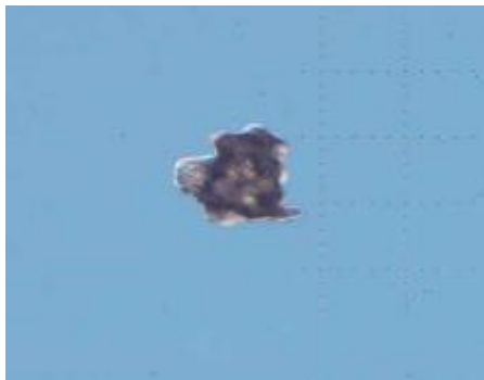
图 155 附着在 4H-SiC 外延层表面上的掉落颗粒物显微镜图象 (100 倍)
