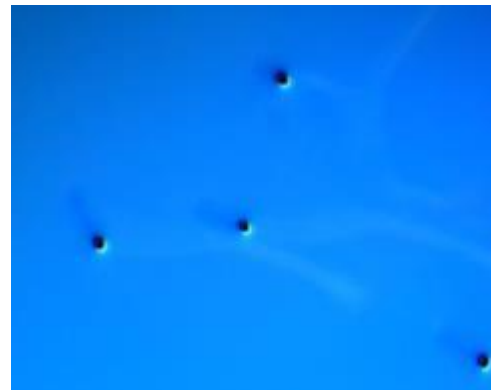
图 76 C 包裹体引起的表面形貌缺陷 (600 倍)
