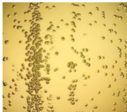
图 44 4H-SiC 外延层小角晶界 (KOH 腐蚀, 630 倍)
