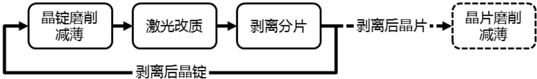
图1 SiC 晶体激光剥离工艺流程图
